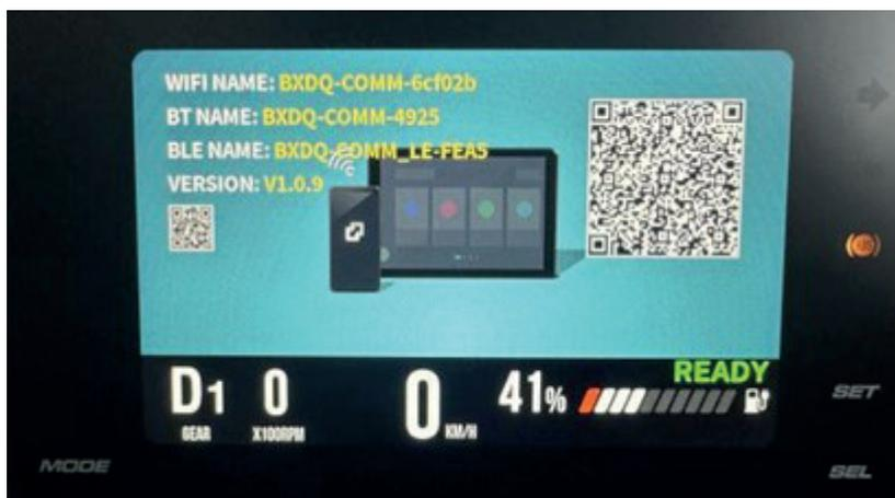
Sur l'interface principale de l'instrument, appuyez sur le bouton MODE dans le coin inférieur gauche pour accéder à l'interface de navigation de projection d'écran. Utilisez votre téléphone portable pour scanner le code QR ci-dessus et télécharger le logiciel MOTOFUN. Après avoir
